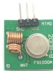
Um den Sender zu verkabeln, wird der Data-Pin mit Pin 10 des Arduinos, VCC mit 5V und GND mit GND verbunden.
